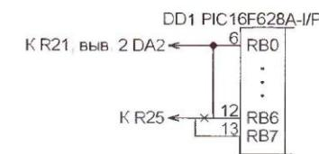
Для работы с новым вариантом программы в измеритель необходимо внести изменения в соответствии с **рисунком**. Провод от резистора R25 перенести с вывода 12 на бывший свободный вывод 13 микроконтроллера DD1, а освободившийся вывод 12 соединить с выводом 6.
