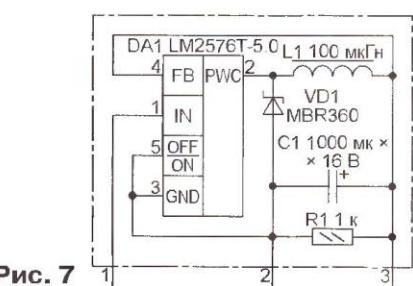
стабилизатор 7805, на микросхеме импульсного стабилизатора LM2576T-5.0, достаточно добавить к ней всего три элемента: диод Шоттки, дроссель и оксидный конденсатор. Резистор R1, создающий необходимую для правильной работы импульсного стабилизатора минимальную нагрузку, не требуется, если
