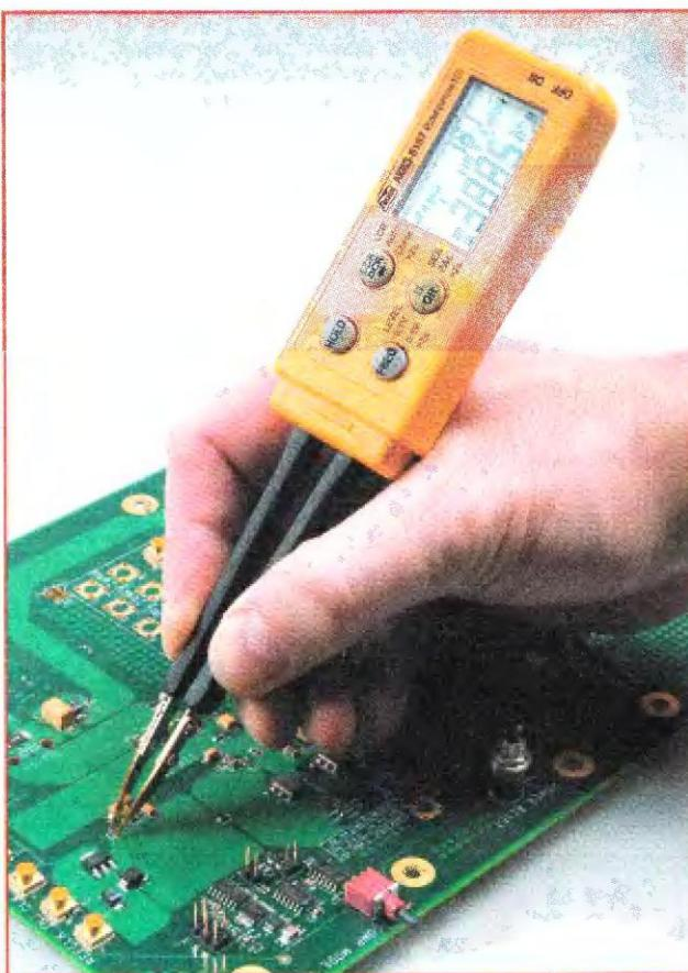
или катушку индуктивности), выбирает подходящий диапазон и частоту тестового сигнала для наибольшей точности измерений. Параметры тест-сигнала (только для АКИП-6107) и режим измерений могут быть заданы пользователем в ручном режиме. Измеритель АКИП-6106 имеет возможность ручного выбора и фиксации предела измерения.
