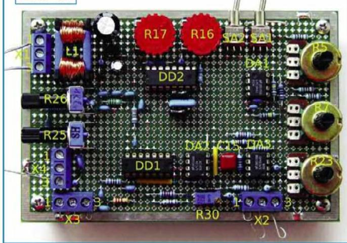
Все узлы ГКЧ питаются стабилизованным напряжением +5 В от стабилизатора DA4. Дроссель L1 подавляет помехи, которые могут проникнуть от сетевого источника питания. Потребляемый ГКЧ ток — около 18 мА.
