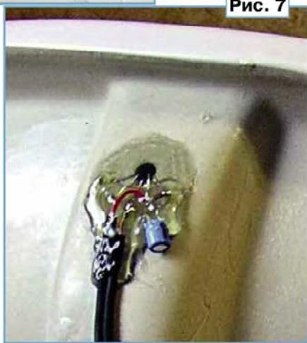
вод взят с катушки магнитного пускателя ПМЕ-200). Переделанный клапан уверенно открывается при 10 В, а его обмотка не перегревается. Хотя катушки электромагнитных клапанов не имеют никакого контакта с водой, для повышения надёжности я залил их эпоксидным компаундом.
