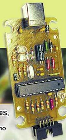
«USB программатор микроконтроллеров AVR и AT89S, совместимый с AVR910».
