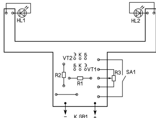
пластиковой матовой трубки для светодиода. Между трубкой и платой установлен светоотражающий пластиковый экран, он защищает пальцы от засветки. Меняя ток через светодиоды, можно менять цвета свечения трубки во время рисования. Схема устройства представлена на рис. 4. На транзисторах VT1, VT2 собран ограничитель тока. При указанном на схеме сопротивлении резистора R2 суммарный ток через све-
