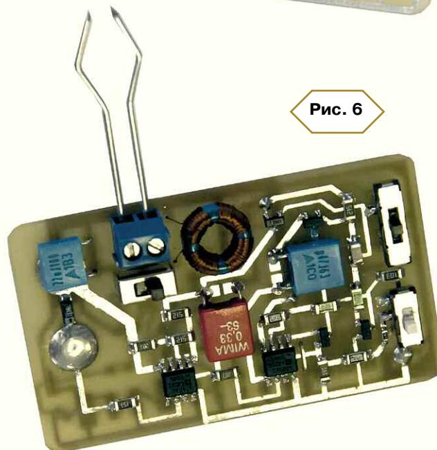
внешняя — R22C12 сглаживают импульсы пилообразной формы до среднего за период значения, которое равно четверти амплитудного. Так, при амплитуде "пилы" на разъёме XP2 "V $\Omega$ mA" 0,8 В напряжение на входе АЦП мультиметра равно 200 мВ, что соответствует верхней границе измерения постоянного напряжения на пределе 200 мВ.
