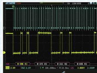
Декодирование последовательных шин
