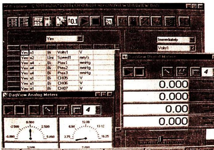
Рис. 1.1. Экранные меню виртуального измерительного прибора
