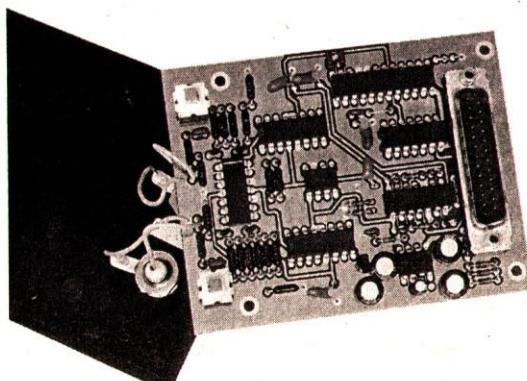
Рис. 3.5. Внешний вид платы АЦП ADC 100
