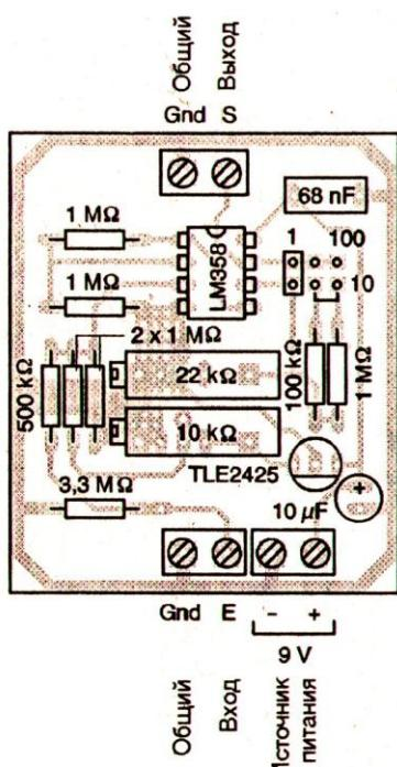
Рис. 6.3. Монтажная схема входного усилителя
