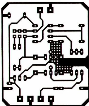
Рис. 6.2. Топологическая схема печатной платы входного усилителя
