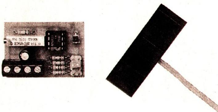
Рис. 6.19. Внешний вид фотометрического датчика
