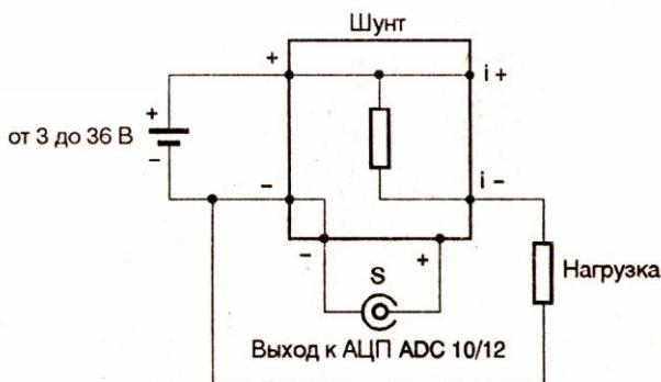
Рис. 6.22. Схема питания устройства от измеряемой цепи
