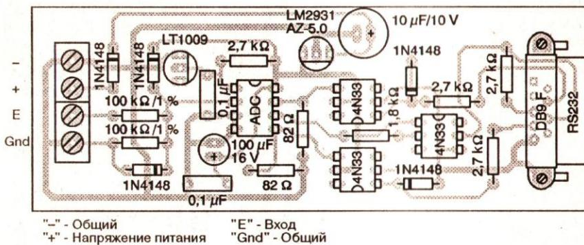
Рис. 4.15. Монтажная схема последовательного АЦП с оптронной развязкой
