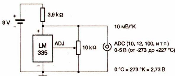
Рис. 6.6. Принципиальная схема датчика температуры
