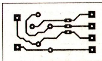
Рис. 6.7. Топологическая схема печатной платы датчика температуры
