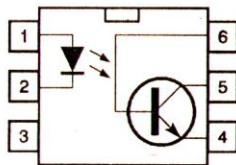
Рис. 4.12. Схема и расположение выводов типового оптрана
