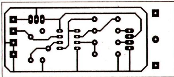
Рис. 6.13. Топологическая схема печатной платы датчика давления
