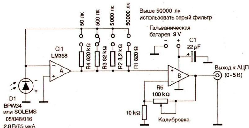
Рис. 6.16. Принципиальная схема люксметра
