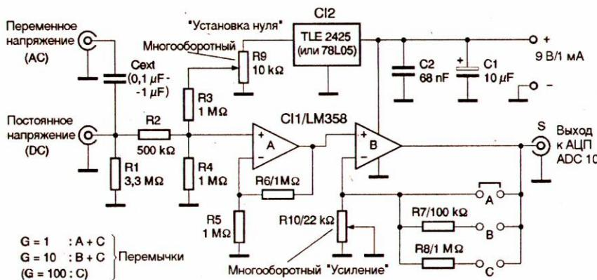
Рис. 6.1. Принципиальная схема входного усилителя
