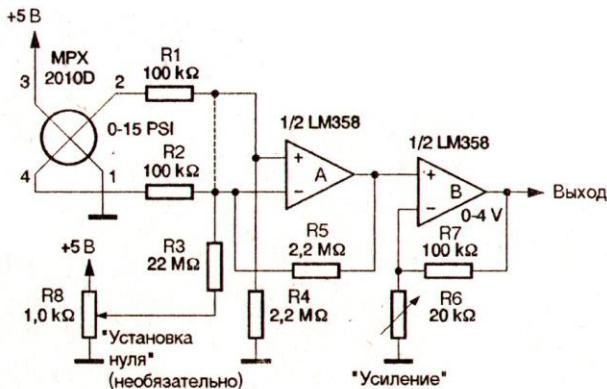
Рис. 6.12. Схема устройства согласования для датчика давления
