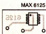
Рис. 4.10. Монтажная схема ИОН для версии компании MAXIM
