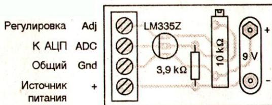
Рис. 6.8. Монтажная схема датчика температуры
