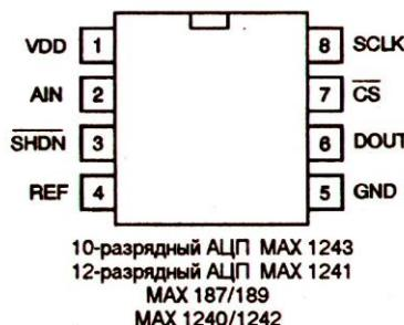
Рис. 2.7. Расположение выводов АЦП MAX 1243
