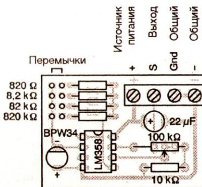
Рис. 6.18. Монтажная схема фотометрического датчика
