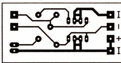
Рис. 6.23. Топологическая схема печатной платы датчика тока
