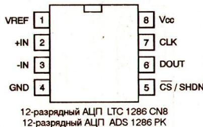
Рис. 2.10. Расположение выводов АЦП LTC 1286 и ADS 1286
