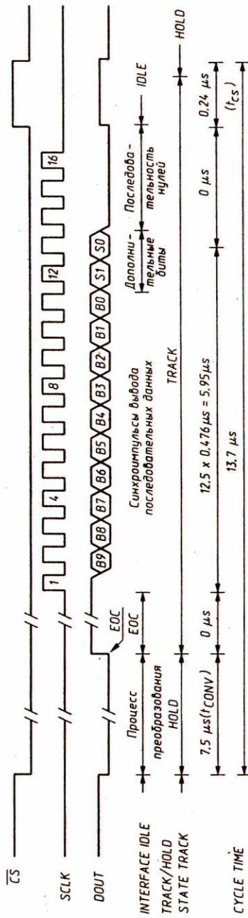
Рис. 2.8a. Протокол связи АЦП MAX 1243
