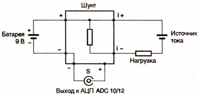
Рис. 6.21. Схема питания устройства от гальванической батареи
