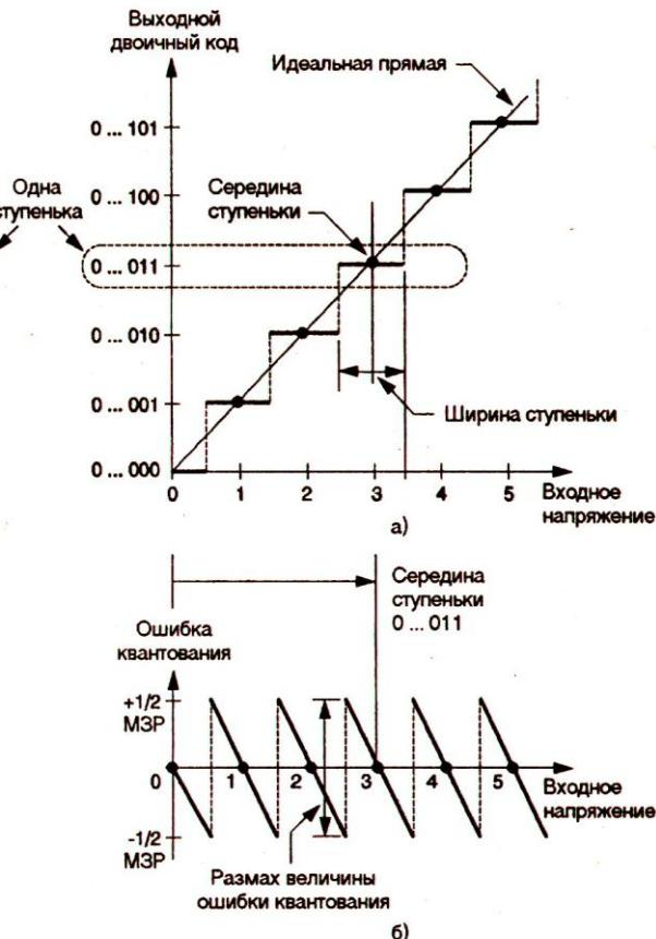
Рис. 2.3. Передаточная характеристика АЦП и таблица кодов преобразования
