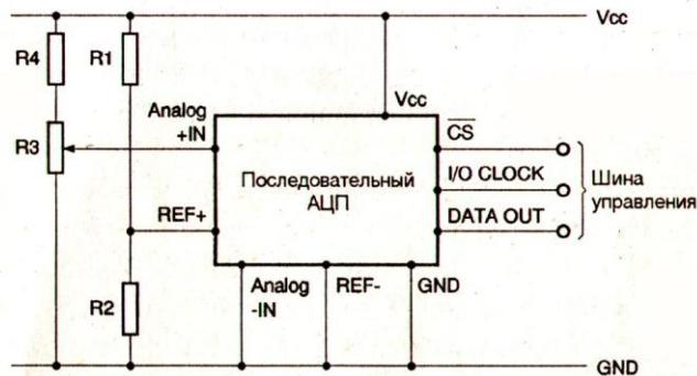
Рис. 2.16. Пример схемы относительного преобразования
