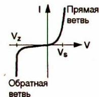
Рис. 2.15. Вольт-амперная характеристика стабилитрона
