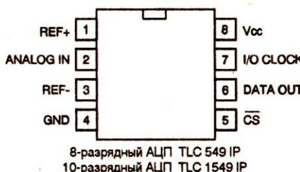
Рис. 2.4. Расположение выводов аналогово-цифрового преобразователя TLC 549
