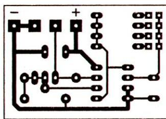
Рис. 6.17. Топологическая схема печатной платы фотометрического датчика
