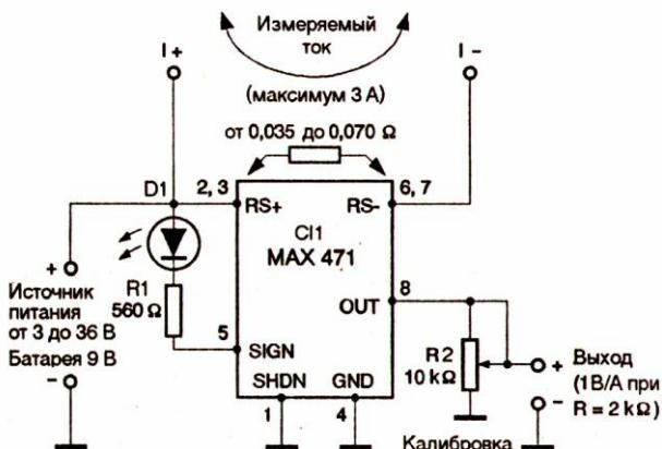
Рис. 6.20. Принципиальная схема датчика тока
